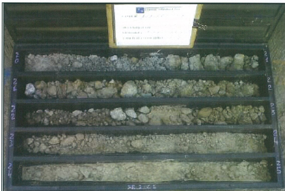
Foto 23. Cassetta S3C5 (profondità da 20,00 m a 25,00 m).
