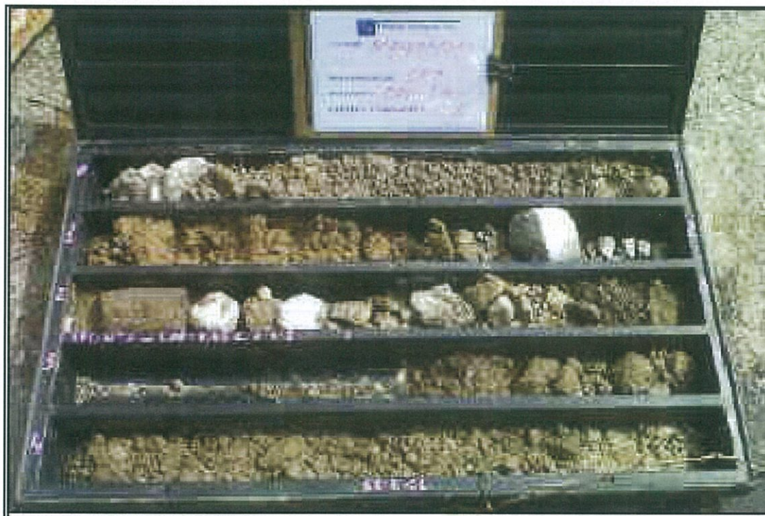
Foto 11. Cassetta S2C1 (profondità da 0,00 m a 5,00 m).
