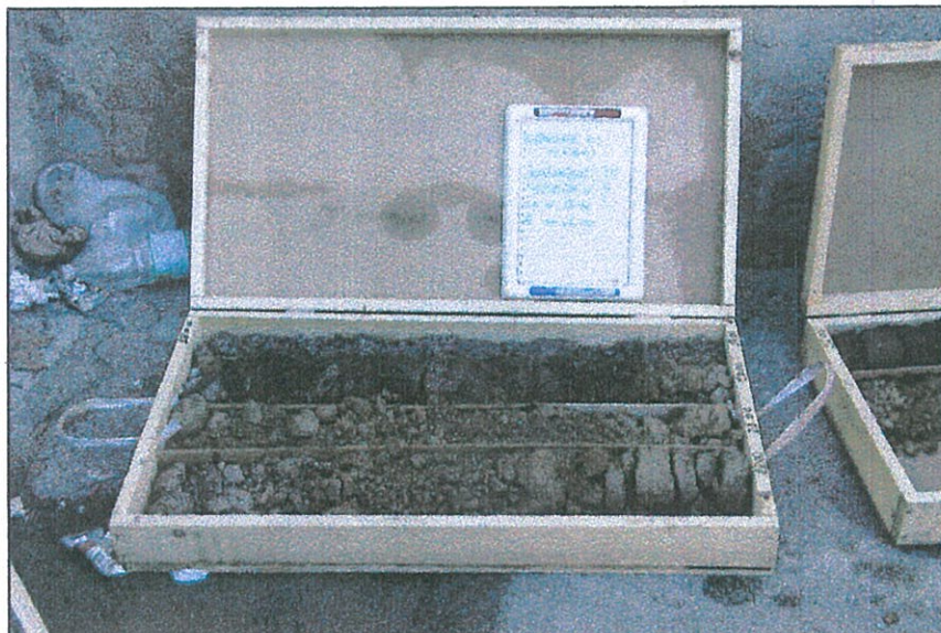
Sondaggio S1 - Cassetta n° 5 da m 18.00 a m 22.00
