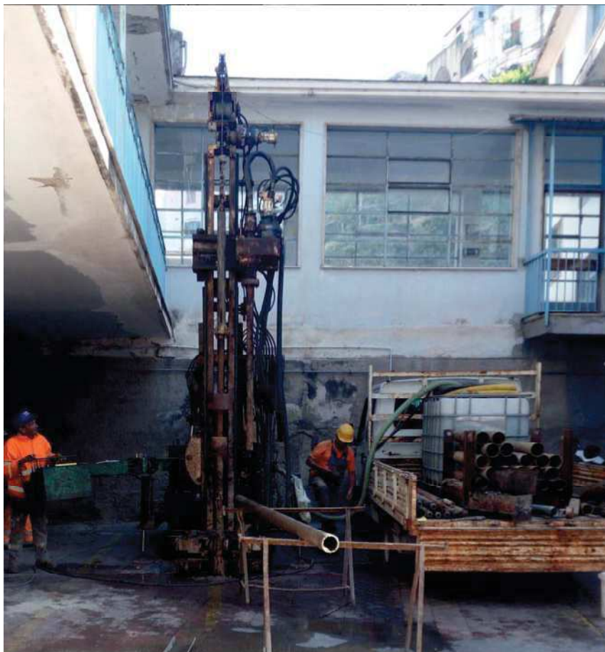
FOTO 1: Sondaggio geognostico a carotaggio continuo S1- esecuzione di prova penetrometrica dinamica S.P.T.
