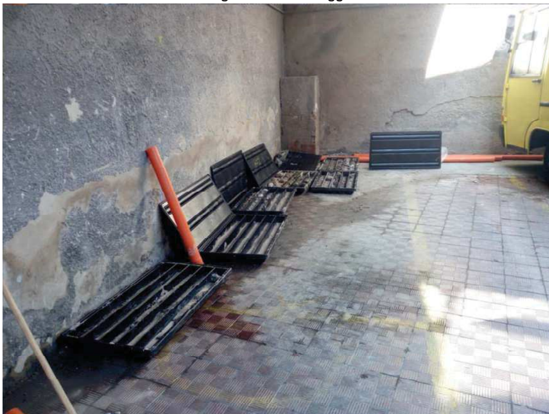
FOTO 2: Panoramica delle cassette catalogatrici del Sondaggio S1
