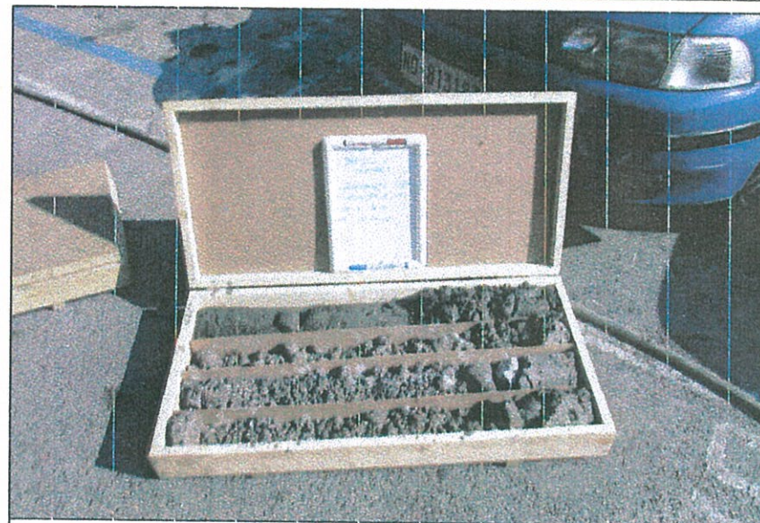
Sondaggio S2 - Cassetta n° 4 da m 12.00 a m 16.00
