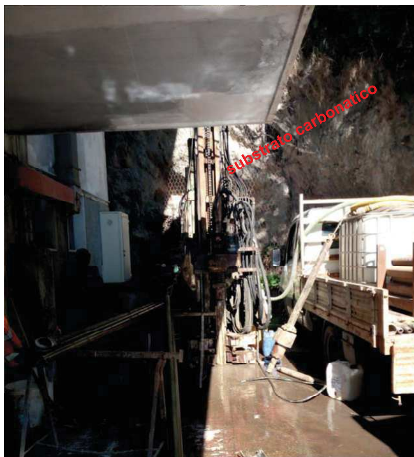
FOTO 9: Sondaggio geognostico a carotaggio continuo S2 con alle spalle la scarpata in roccia carbonatica
