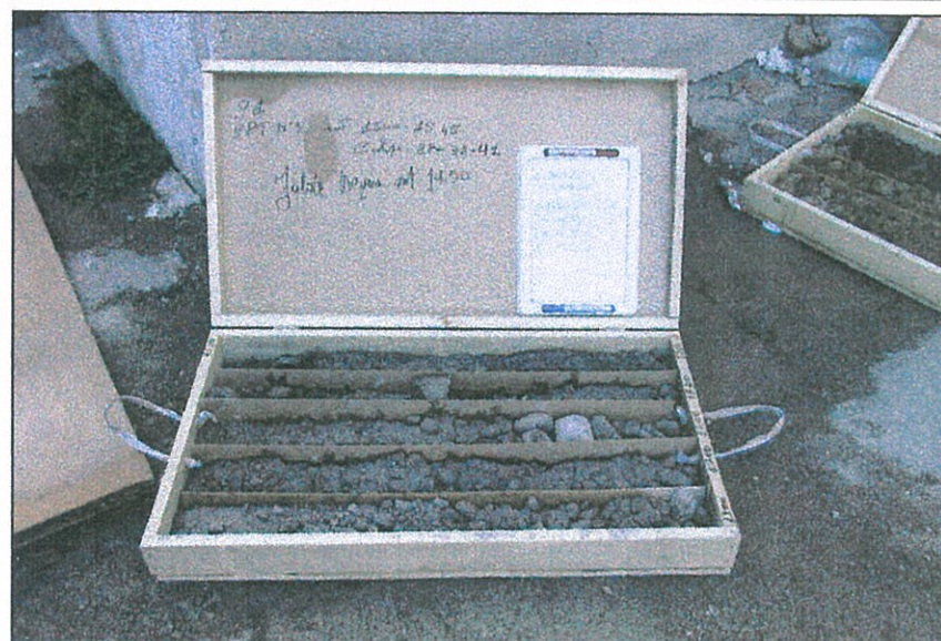
Sondaggio S1 - Cassetta n° 4 da m 13.00 a m 18.00
