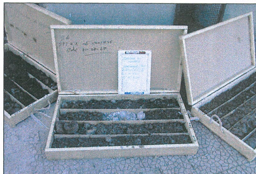
Sondaggio S1 - Cassetta n° 2 da m 4.00 a m 8.00
