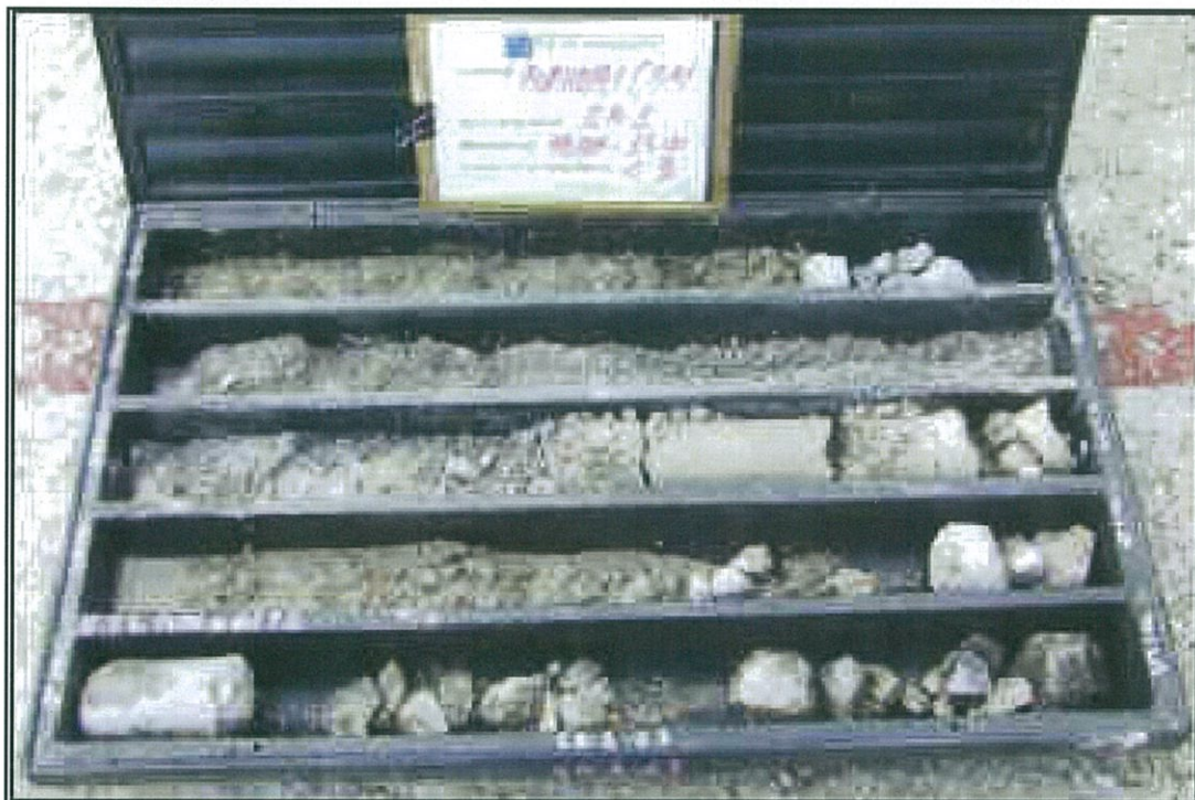
Foto 5. Cassetta S1C3 (profondità da 10,00 m a 15,00 m).
