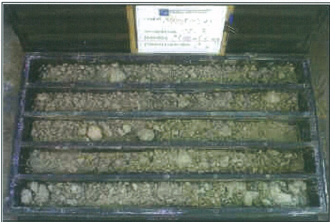
Foto 24. Cassetta S3C6 (profondità da 25,00 m a 30,00 m).
