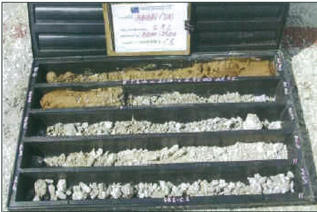
Foto 7. Cassetta S1C5 (profondità da 20,00 m a 25,00 m).
