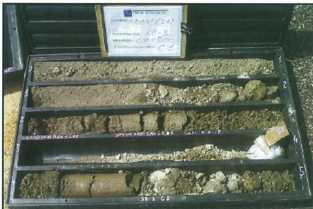
Foto 19. Cassetta S3C1 (profondità da 0,00 m a 5,00 m).
