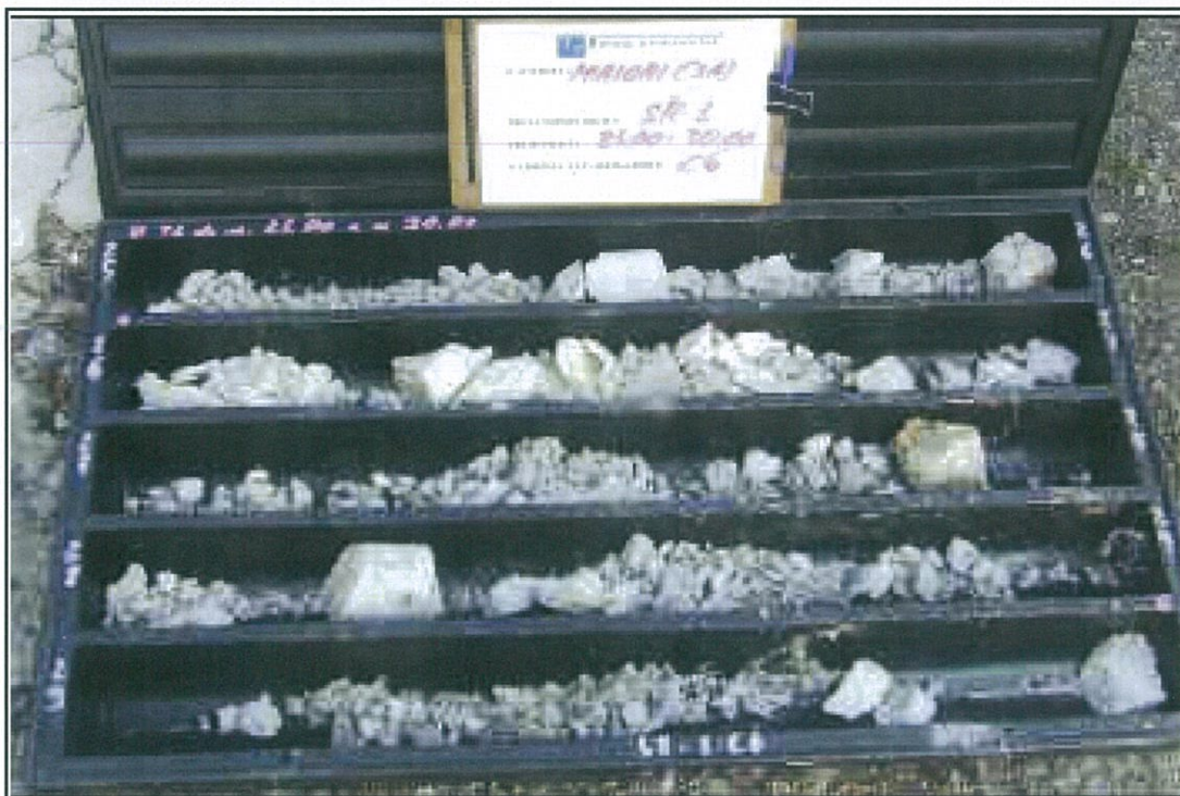
Foto 8. Cassetta S1C6 (profondità da 25,00 m a 30,00 m).
