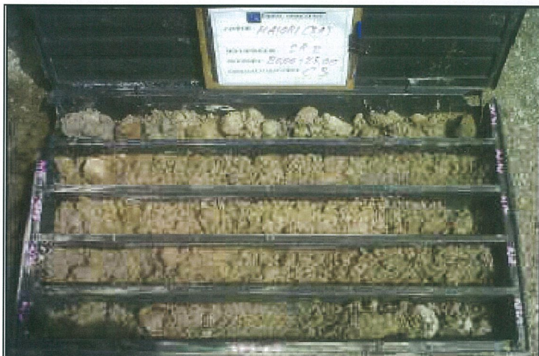
Foto 15. Cassetta S2C5 (profondità da 20,00 m a 25,00 m).
