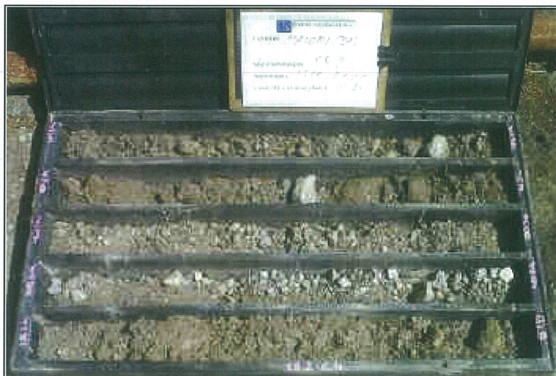
Foto 14. Cassetta S2C4 (profondità da 15,00 m a 20,00 m).
