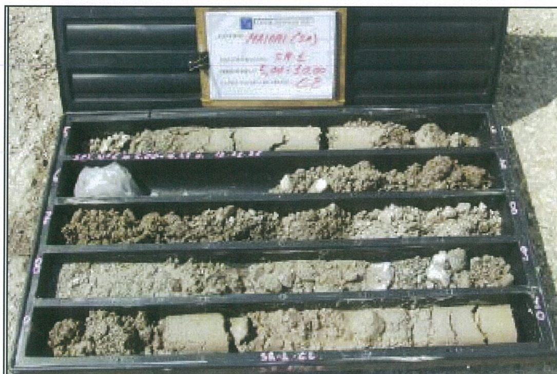
Foto 4. Cassetta S1C2 (profondità da 5,00 m a 10,00 m).
