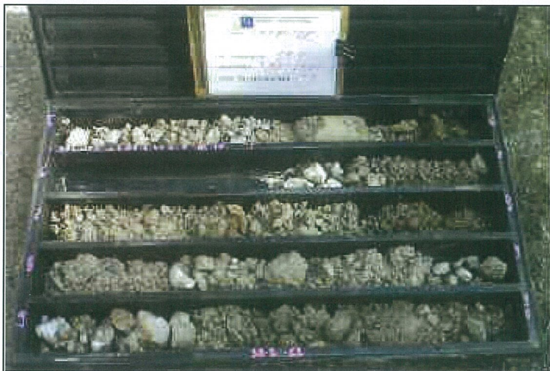
Foto 12. Cassetta S2C2 (profondità da 5,00 m a 10,00 m).
