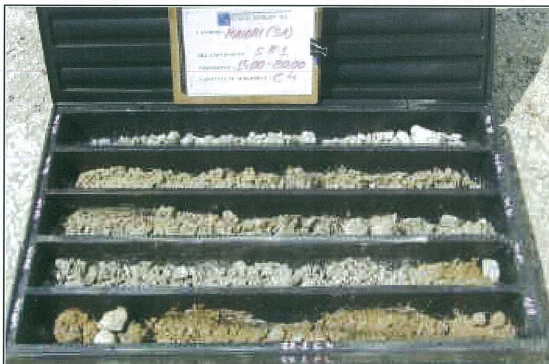
Foto 6. Cassetta S1C4 (profondità da 15,00 m a 20,00 m).
