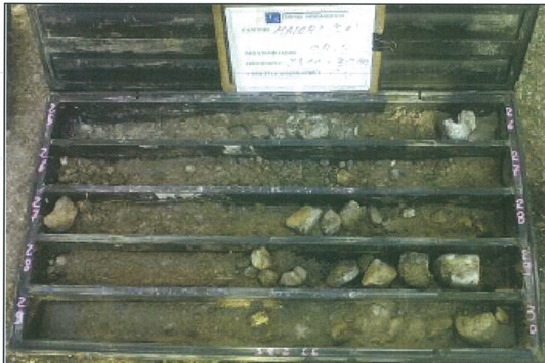
Foto 16. Cassetta S2C6 (profondità da 25,00 m a 30,00 m).
