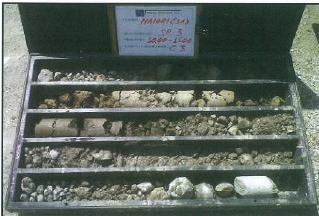
Foto 21. Cassetta S3C3 (profondità da 10,00 m a 15,00 m).
