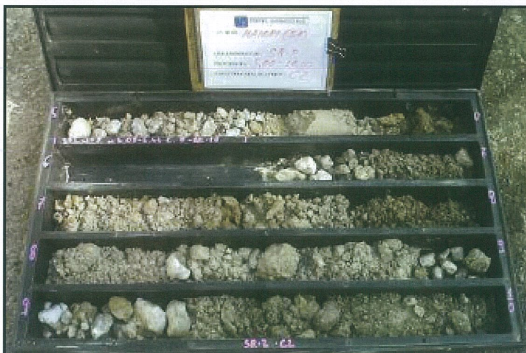
Foto 20. Cassetta S3C2 (profondità da 5,00 m a 10,00 m).
